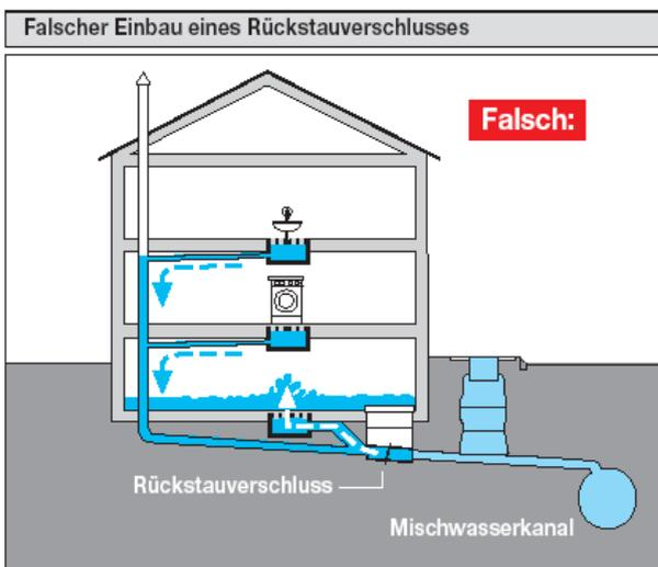
Nur Ablaufstellen unterhalb der Rückstauenebene dürfen gegen Rückstau gesichert werden. Alle Ablaufstellen oberhalb der Rückstauenebene sind mit freiem Gefälle am Rückstauverschluss vorbei dem Kanal zuzuleiten.
