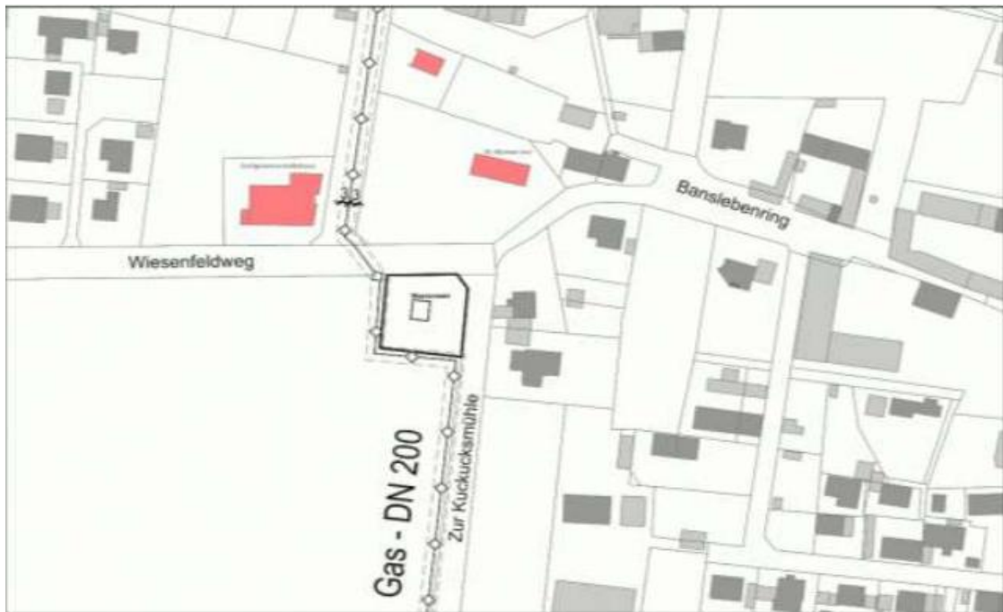
Abb. 7: Verlauf der Gashochdruckleitung am Geltungsbereich
